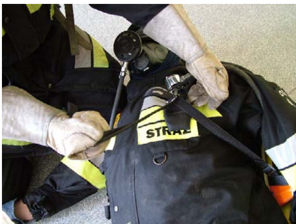
Fot. 1. Luźna taśma ramiennej aparatu uszkodzonego.
