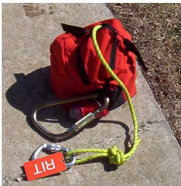
Fot. 2. Lina poszukiwawcza stosowana przez GSR (Zdjęcie udostępnione dzięki uprzejmości Slinger Fire Department - http://slingerfd.com ).
